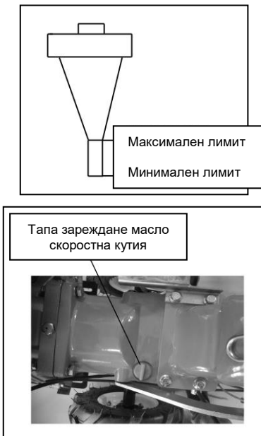
Фиг. 5 – Проверка на нивото на трансмисионното масло
