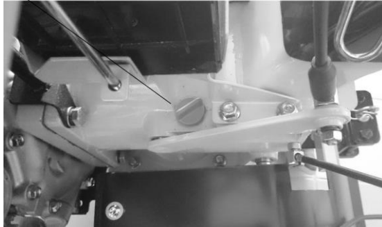
Фиг. 5 – Проверка на нивото на трансмисионното масло
