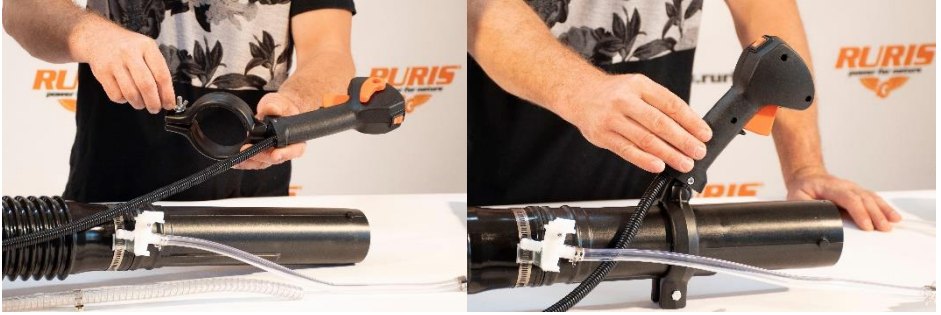
3. Поставете лоста за газта (първо развийте крилчатата гайка).
