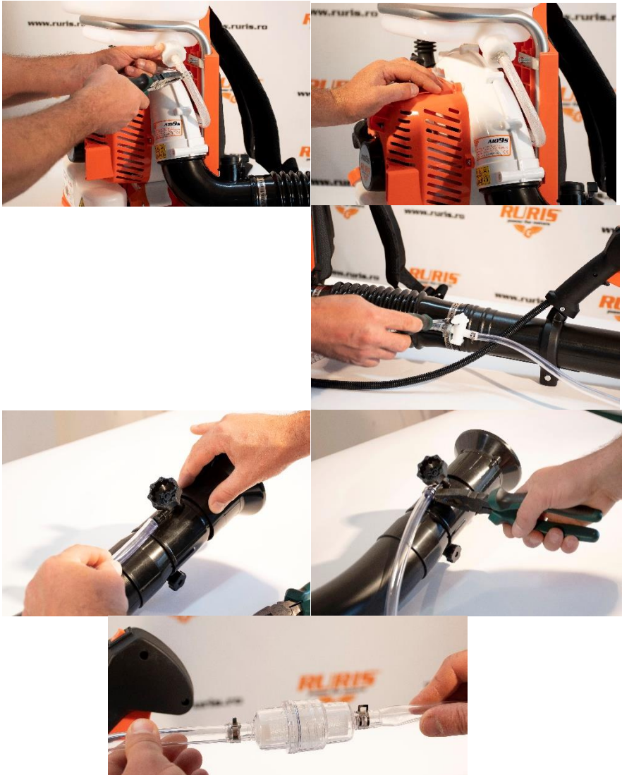
6. Монтиране на маркуците за течност
